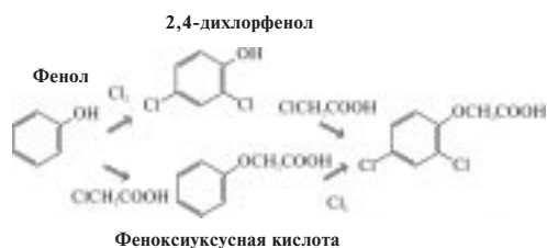
Две схемы синтеза 2,4-Д
